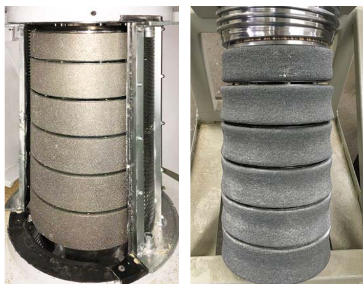
Abb. 1: Links die Diamantschleifscheibe, rechts ausgewaschene herkömmliche Schleifscheibe alle Fotos: ROT®
