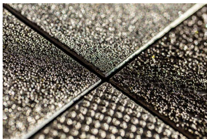
Abb. 2: Austauschbare Segmente auf den Schleifscheiben
