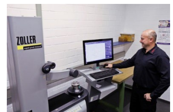
Vermessen der Werkzeuggeometrie im Messraum zur Endkontrolle und Protokollierung.
